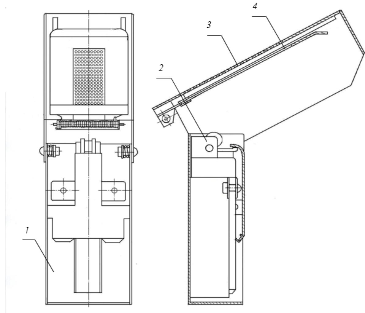
1 – корпус; 2 – газовая зажигалка; 3 – поворотная крышка; 4 – зажимное устройство
